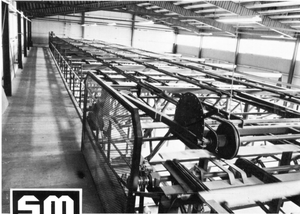
12-facks längdsortering med minnesstyrd kvalitetssortering
