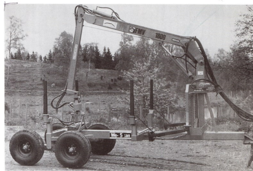
We-5:an med gripl. FMV 1800, armlängd 9,95 m, lyftkraft 275 kg, hydraulvinsch FMV HV 100, mek. stödben.
